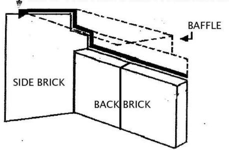
WHEN PUTTING THE BAFFLE INTO THE STOVE TAKE THE FUEL GUARD OUT.
